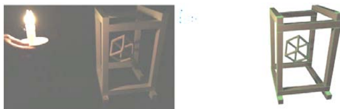
図 7 左: 蠟燭で照らされた Dual Skeleton Cube 右: 推定された 3 次元点光源群 (図中央の色付き点群. 色は光源輝度を表す.)
